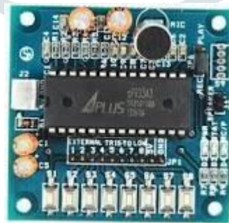
Fig- 6 APR3A3 Voice Module
